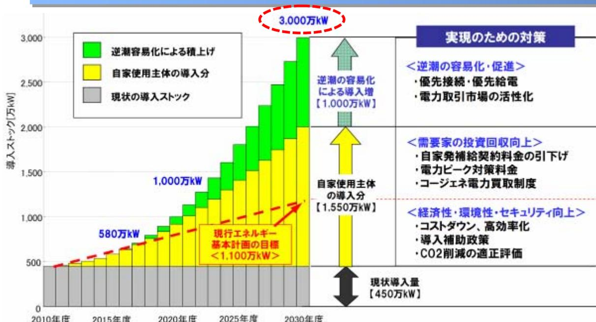
■ 従前のエネルギー基本計画では、現状で約450万kwの天然ガスコージェネレーションシステムについて、2030年に1,100万kwの普及を想定
