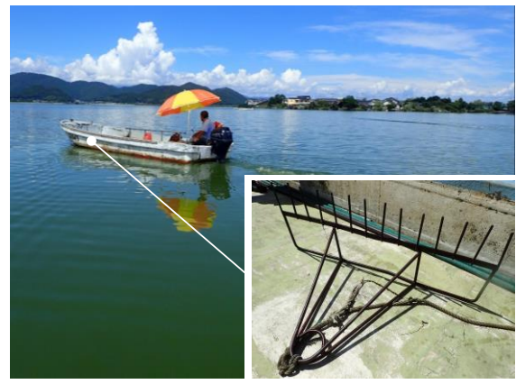
写真2 西の湖での水質改善対策（湖底耕耘）
