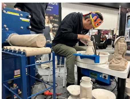
再生された土が押し出されて出てくる様子。
