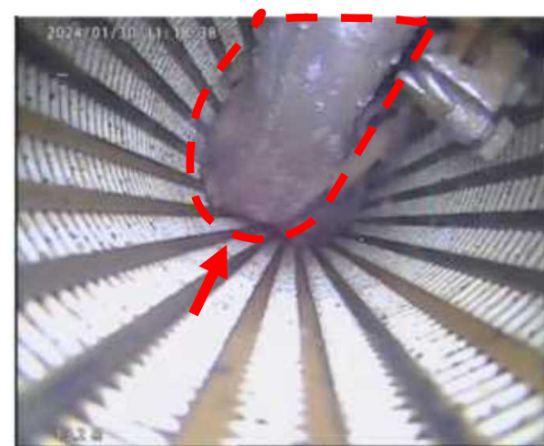
孔内に詰まっている重り(下部)の様子。 その下には詰まっている水質計が見える。
