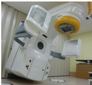
図1 高精度放射線治療装置 (NovalisTx)
