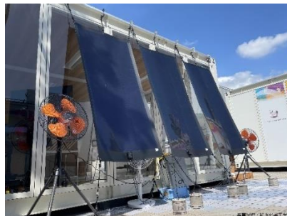
ペロブスカイト太陽電池 8 の活用例 写真提供:積水化学工業(株)
