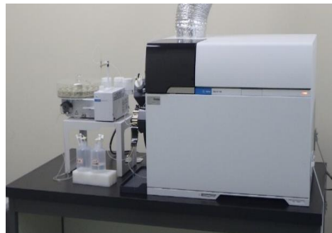
②誘導結合プラズマ質量分析計 (鉄、アルミニウム等の金属)
