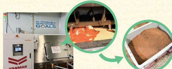
スター)を導入、製造過程で発生した生ごみを毎日100kg、本機で堆肥化。処理後の生成物は専門業者にて回収され、滋賀県内の酪農家などに、良質な堆肥や土壌活性剤、牛糞発酵促進剤として再利用されることで資源循環を実現しています。
