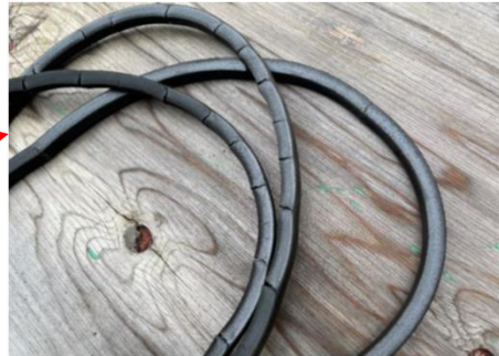
(ベルトに亀裂が入っている)
