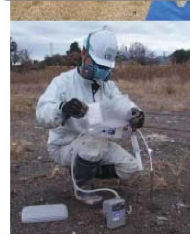
写真-4 表層ガス採取状況
