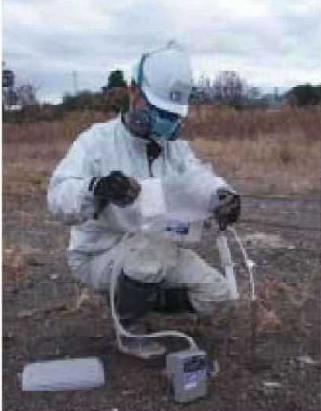
写真-4 表層ガス採取状況
