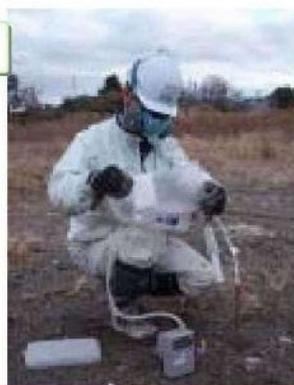
写真-1 ガス採取状況(例)
