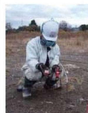
写真-3 携帯型ガス測定器(例) (理研計器製GX-2001等)
