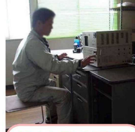
写真-5 ポータブルガスクロマトグラフでのVOC測定
