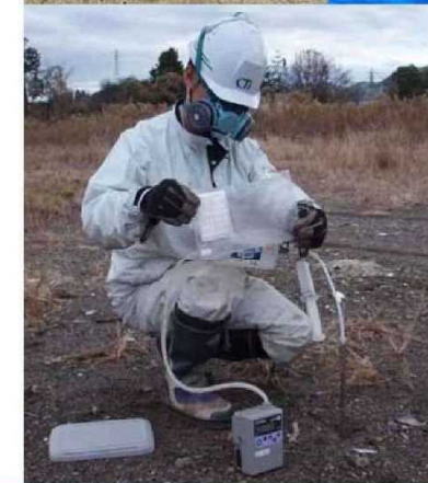
写真-4 表層ガス採取状況
