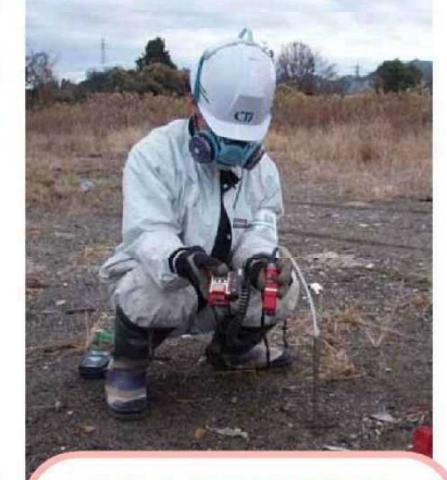
写真-6 携帯型ガス測定器(理研計器製GX-2001等)での発生ガス測定
