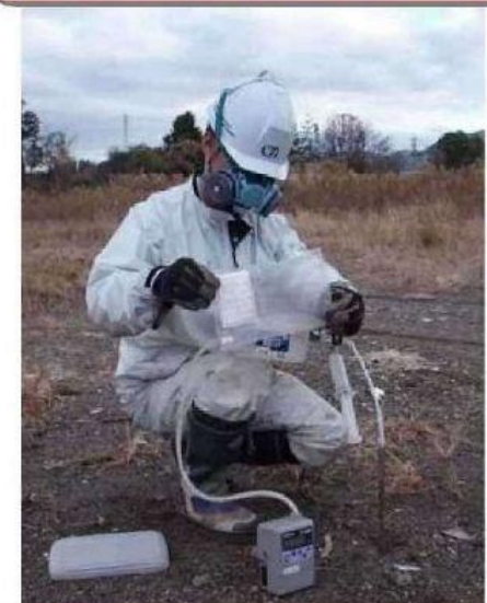
写真-4 表層ガス採取状況
