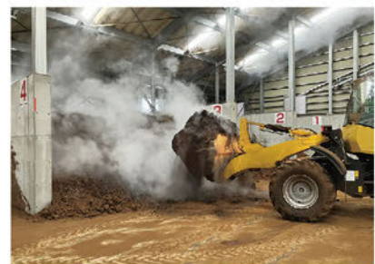
上：コンポスト化施設外観 下：発酵中の污泥は90度近い高温で、攪拌作業により水蒸気が上がっています。
