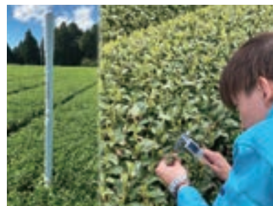
茶園に設置した温度・湿度センサー（左） と実測値測定（右）
