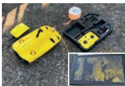
水中ドローンによる機能診断
