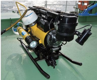
写真5-3-1 有索型水中ロボット(ROV)
