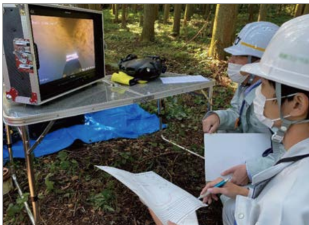
用水路の内部状況を診断するためのビデオカメラ調査
