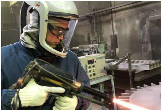
溶射とは、金属やセラミックス、サーメットなどを、熱源を用い溶融噴射し、基材表面に材料を噴きつけて機能皮膜を形成する表面改質技術です。
