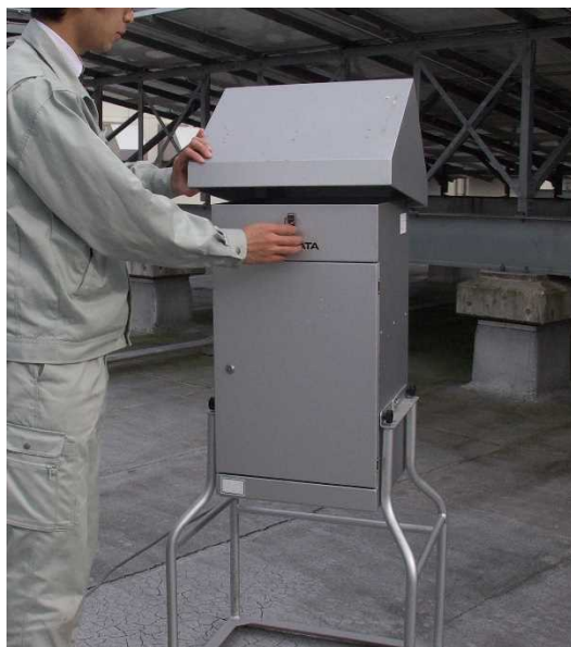
大気圏担当の実験室 (ハイボリューム・エア・サンプラー)
