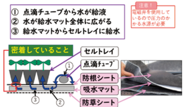
図2 底面給水育苗の構造
