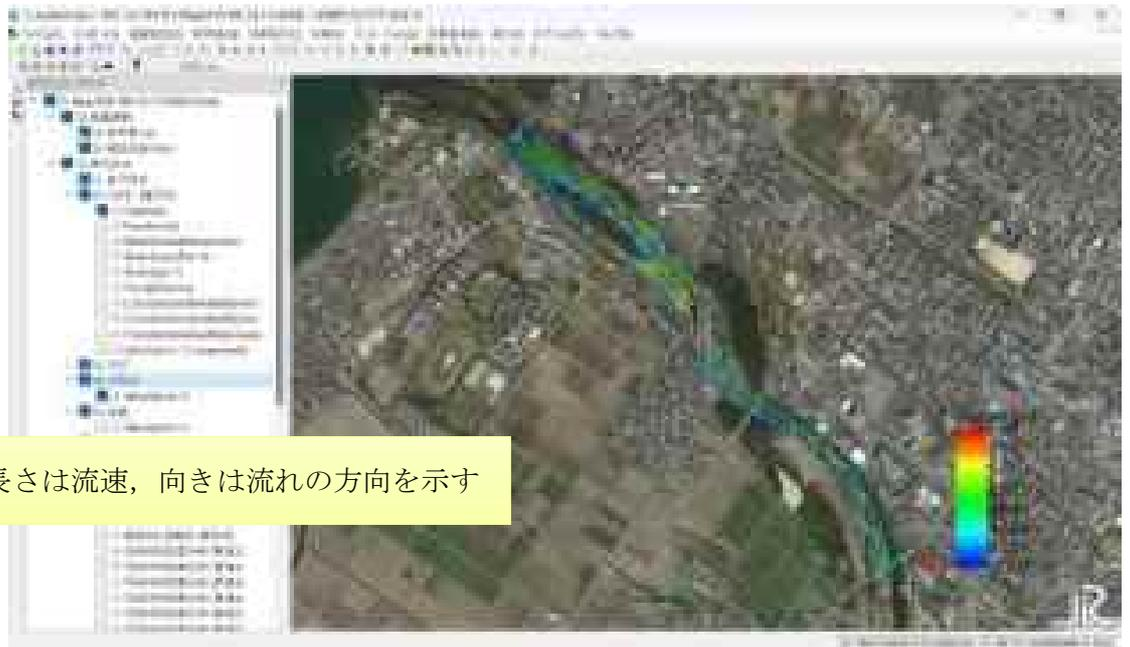
矢印の長さは流速, 向きは流れの方向を示す
