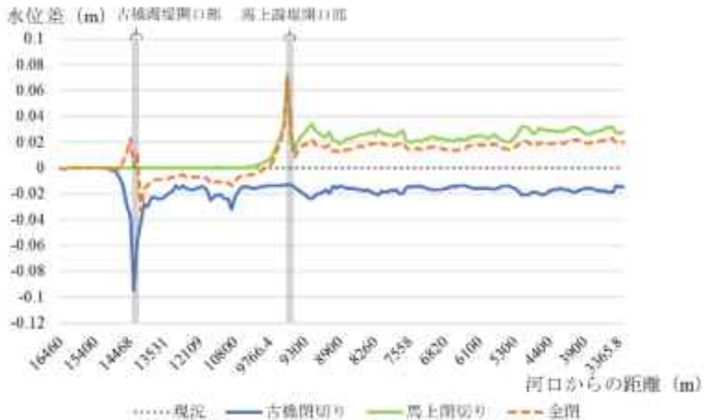
図 2022 年 8 月豪雨時に霞堤が下流水位に与えた影響 (シミュレーション)
