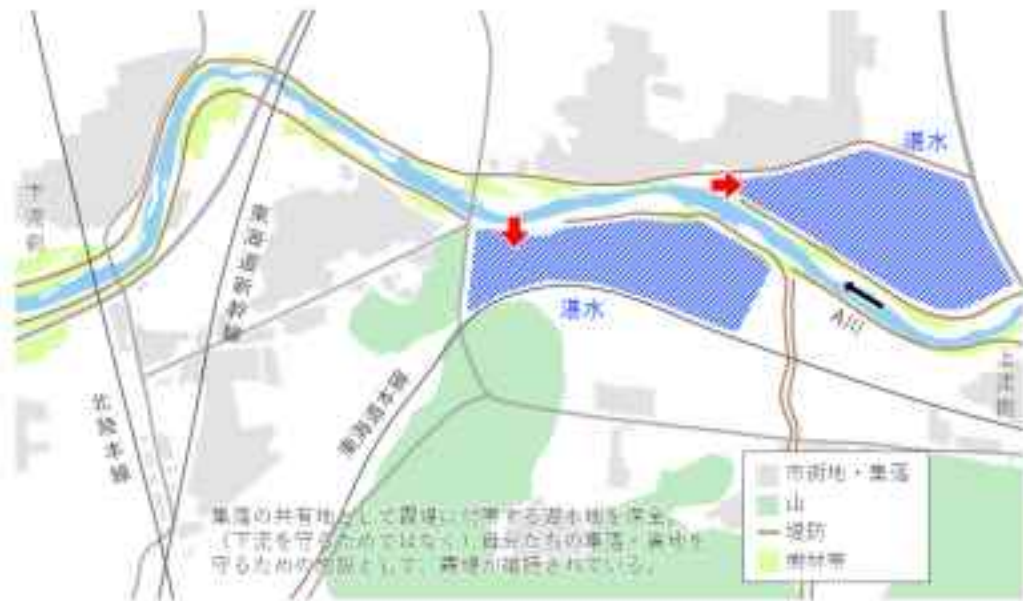
図 霞堤の配置，受益と負担が同一あるいは近いコミュニティの場合に維持される。
