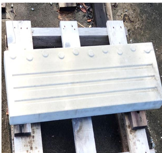
ジオポリマーコンクリートで試作した車止め ※琉球大学にて試作 卵殻、殻椰子柄焼却灰等を使用
