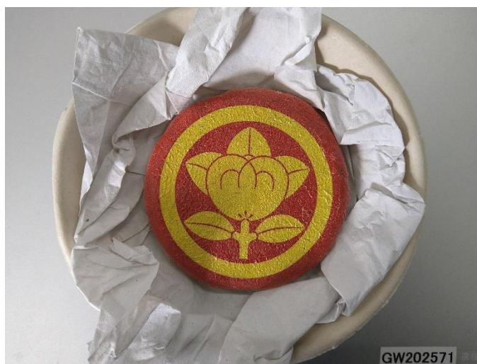
ジオポリマーコンクリートに印字したデザイン (サンプル:井伊家の家紋)
