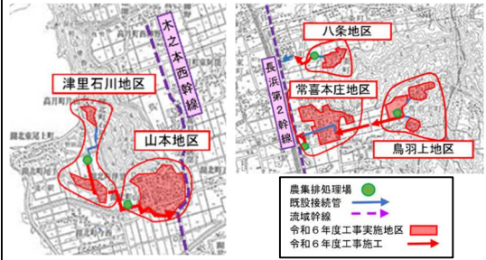
農業集落排水施設の接続事例(長浜市 令和6年度)
