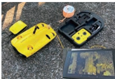
水中ドローンによる機能診断
