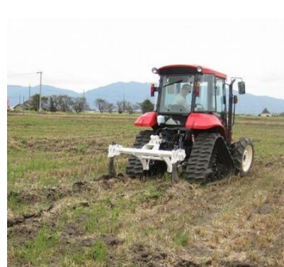
つなぎ目はしっかりつなぐ！ 弾丸暗きょは明きょとつなぐ！ 心土破碎で排水性向上！
