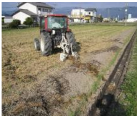
つなぎ目はしっかりつなぐ！ 弾丸暗きょは明きょとつなぐ！ 心土破碎で排水性向上！
