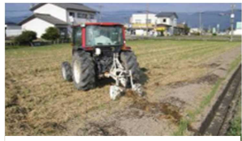
弾丸暗きよの施工の様子
