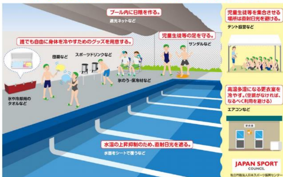
図3-2 屋外プールでの熱中症対策例
