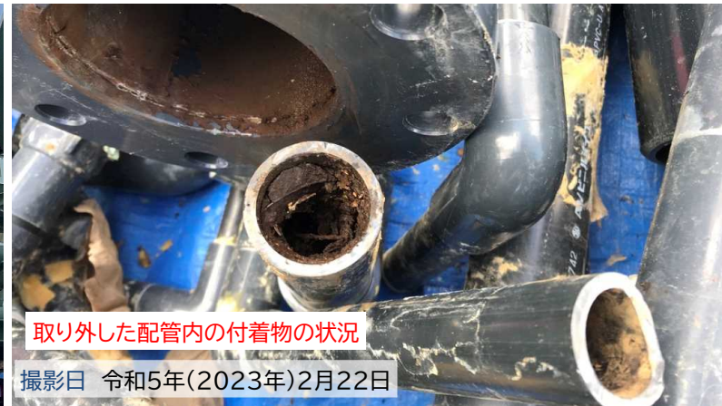
内側に付着物の付いた配管の更新
