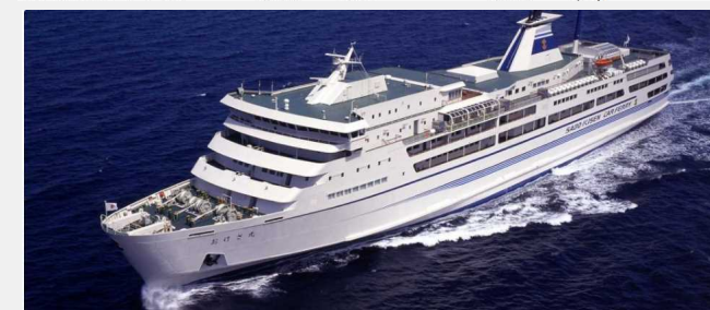
船名 おけさ丸 最大旅客定員 1,705人 車両積載能力 大型バス32台 乗用車48台 または 乗用車290台 総トン数 5,855トン 最大速力 23.4ノット 全長 134.7m 最大幅 21.0m 主機の種類 ディーゼル 建造年月 平成5年4月
