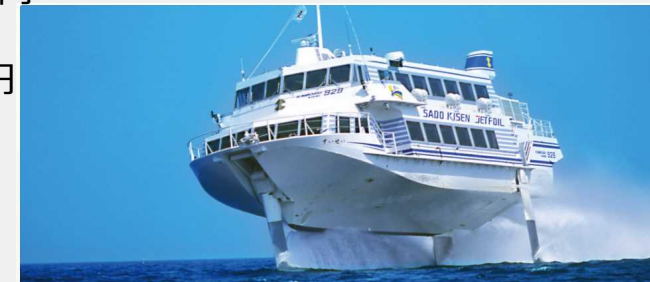
ジェットfoil 船名 ぎんが・つばさ・すいせい 最大旅客定員 250人 新潟～両津航路、直江津～小木航路 最大速力 46ノット 最高出力 7,600ps
