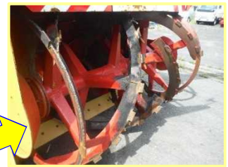
交換部品がなく、溶接等で延命化を図っている状況
