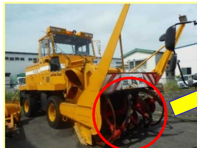
雪寒用建設機械の損傷状況 (除雪ローダ(購入後24年))
