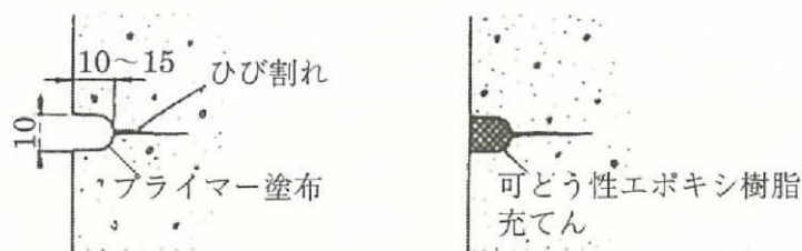
図-3.2.4 ひび割れ充填工の概要図 1)
