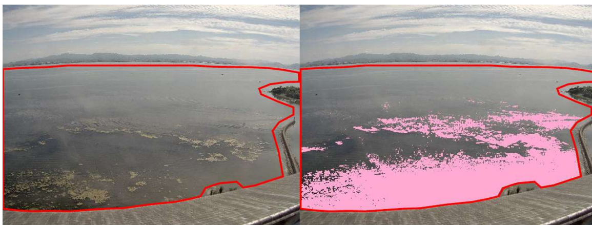
図 19. 琵琶湖グランドホテルに設置した定点カメラ画像 (2019 年 9 月 20 日) における水草判別推定法の適用結果.
