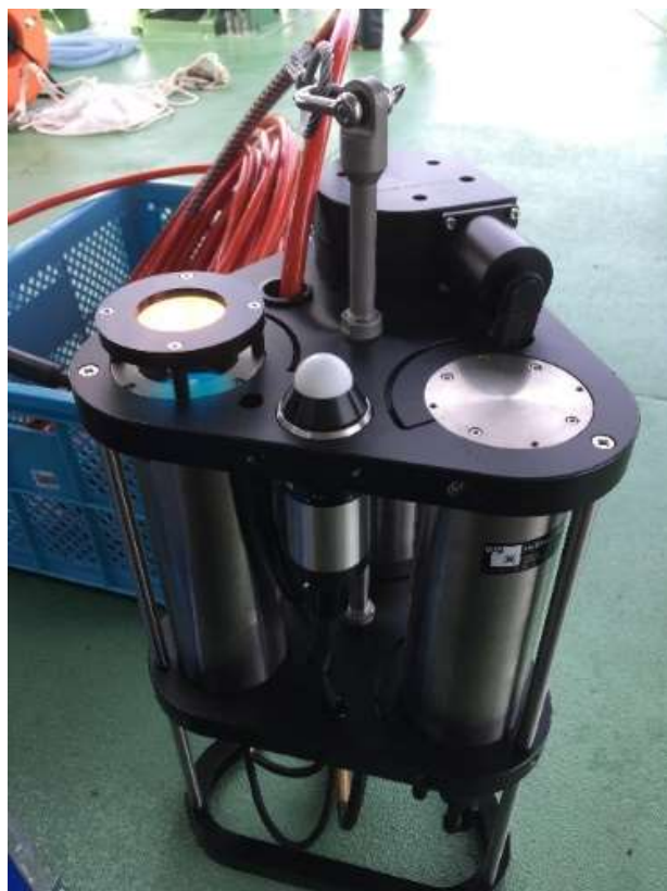
図 11. 高速フラッシュ蛍光光度計, FastOcean.
