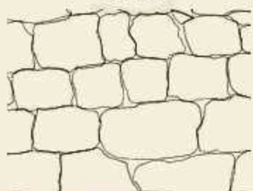
目が横に通るように積み上げる方法
