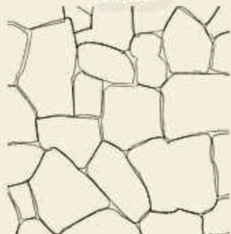
平石をさまざまな方向に組み合わせ積み上げる方法
