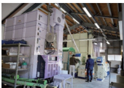
乾燥機3台導入 (照明のLED化、扇風機取り付け)
