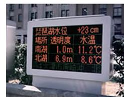
開發當初的透明度自動測量系統，測量結果被公示於縣廳前。
