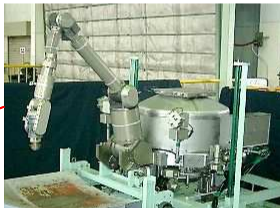
検査用ロボットを用いて 容器の内側を検査します。
