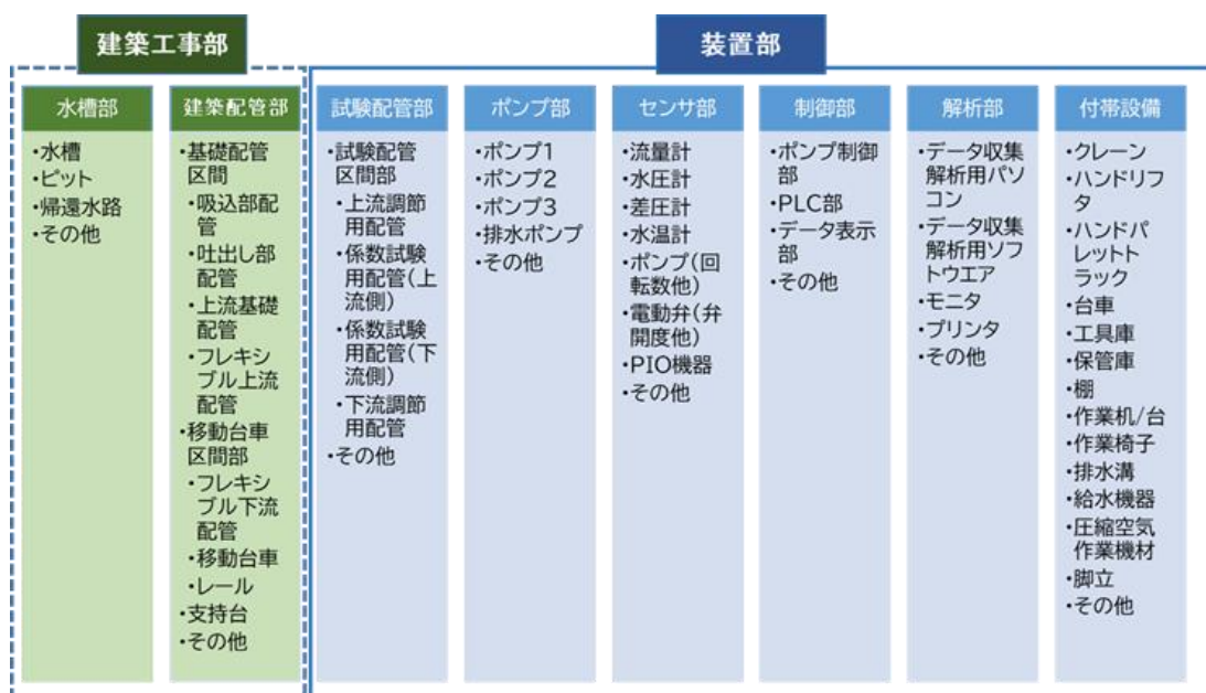
図 6 試験設備の主要構成
