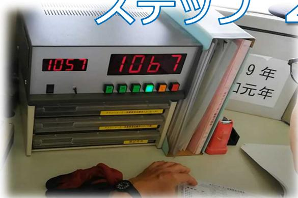
つぎに、基準ローラー上を走行した距離と実際にタクシーメーターが作動する距離を確認し、誤差が計量法で定める範囲内か確認します。
