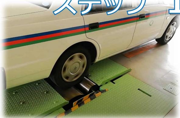
まず、タクシーを基準ローラーのうえに乗せ、安定して走行できるかを確認してから、タクシーメーターを作動させてローラー上での走行検査を開始します。
