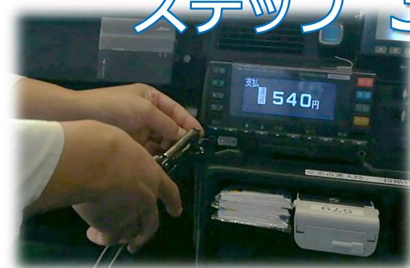
検査に合格すれば、最後にメーターが再調整できないように封印を行い、有効期間を示すシールを貼付します。
