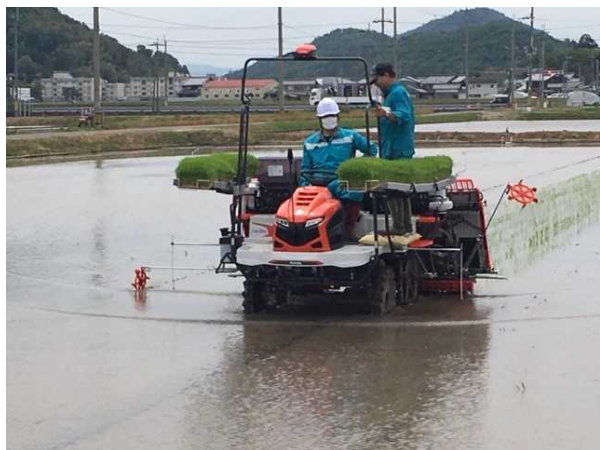
深い水深でも田から水を落とさずに田植えができる 自動直進田植機による田植えの実証
