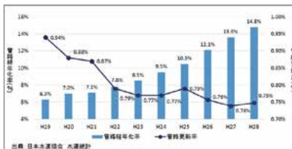
図2 管路の老朽化率と管路更新率
