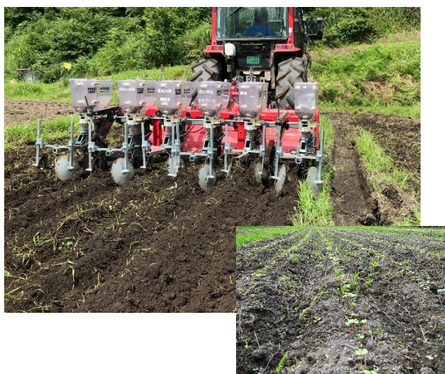
小畦立て装置による播種(8月5日) 畝の上に出芽し湿害を回避
