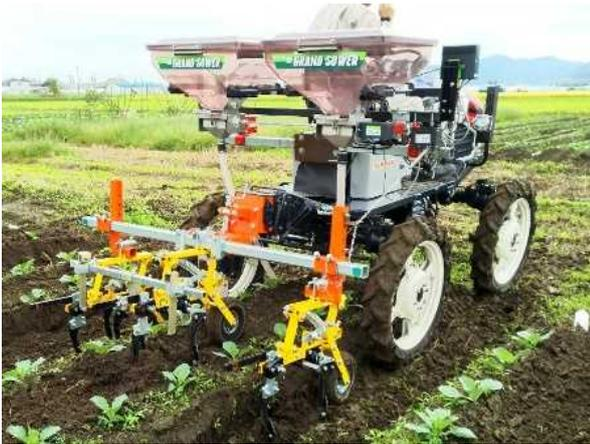
図1 供試したビークル(HV171、ヤンマー)、除草カルチ(S3 カルチ 3 条、キューホー)
