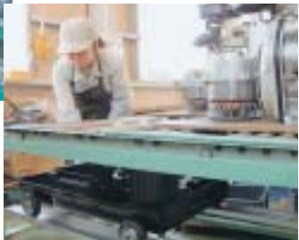
重量のある発電機部品をローラーにのせて軽々と移動。
