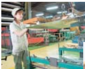
重量のある大型鉄板を磁力で浮き上がらせて運搬。
