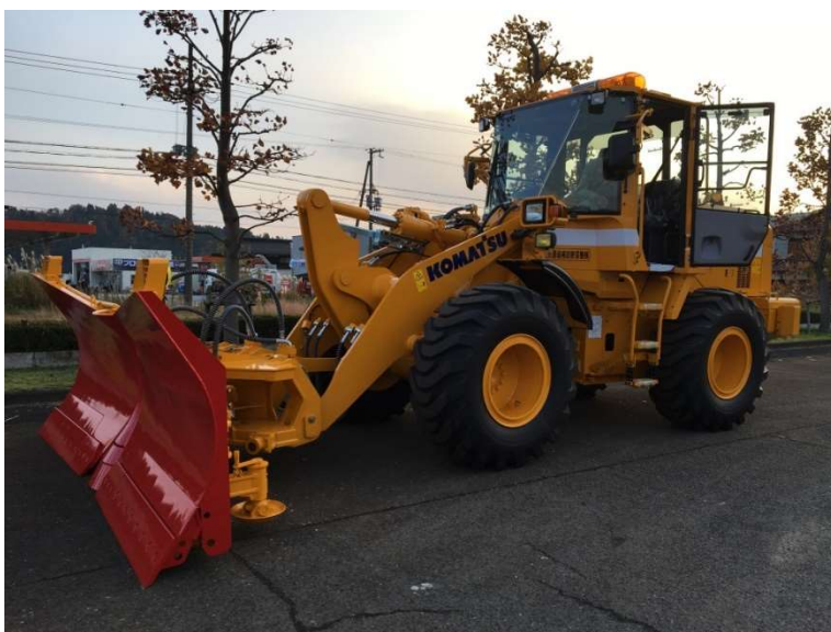
除雪機械の購入(除雪ドーザ)
