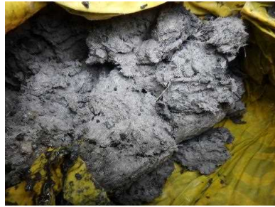
平成29年5月12日 廃石綿等(発塵防止剤)
