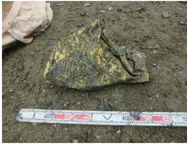
平成29年5月10日 廃石綿等(固結物)
