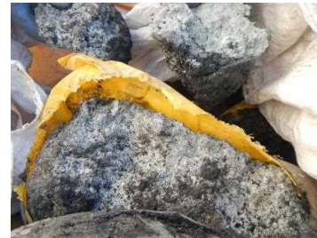
平成29年11月1日 廃石綿等(固結物)
