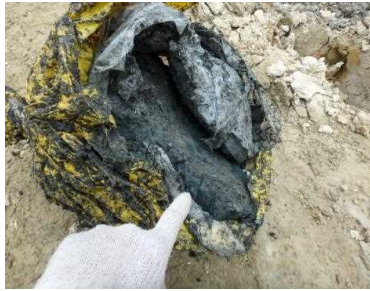
平成29年5月12日 廃石綿等(固結物)
