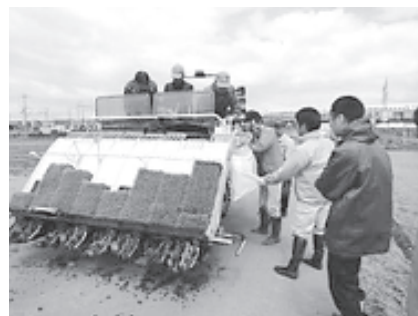
写真 肥料の残量から投入された量を測定
