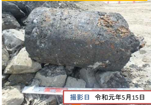
ドラム缶内容物(コンクリート固結物)
